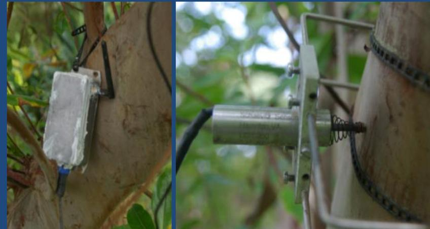
Boitier d'acquisition (à gauche) et capteur Pépipiaf (à droite) (Source : Charron T.)
